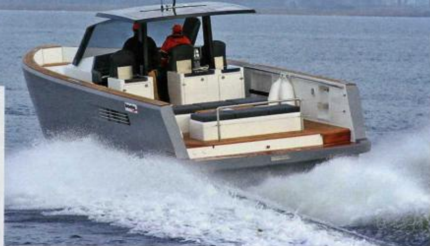
Motorisierung Fjord liefert die 40 open ausschließlich mit zwei Dieselmotoren und IPS-Antrieben. Letztere sitzen unter dem Rumpf.
