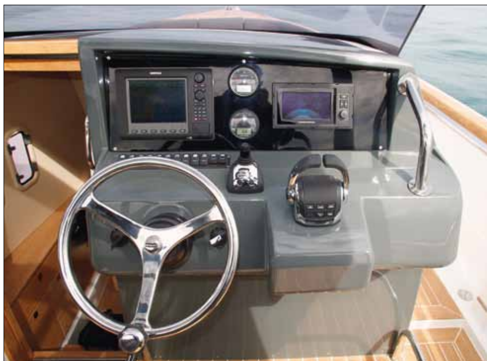
Le traceur (à gauche) et l'ordinateur des moteurs sont parfaitement placés tout comme le volant et la poignée des gaz électrique. Le joystick de manœuvre pour les embases est une option.
