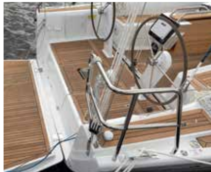
Den normalt lukkede hæk kan vippes ned som badeplatform. Det giver mulighed for at åbne stuverummet til en redningsflåde om bagbord, så flåden kan trækkes direkte ud i vandet over platformen.
